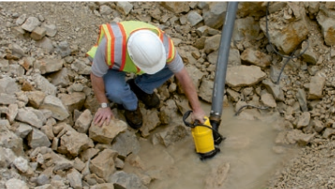
Trockenlaufsichere Elektrotauchpumpen: auch bei langem Schlürfbetrieb dank integriertem Ölverteiler.
